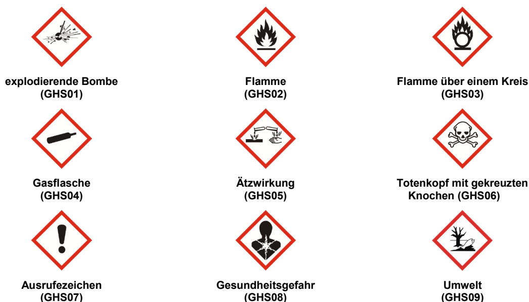
Abbildung 3: Durch die Kennzeichnung der nach ChemG, GefStoffV und CLP-Verordnung eingestufteten Gefahrstoffe mit Gefahrenpiktogrammen wird auf die Hauptgefahren hingewiesen, die bei gebräuchlicher Handhabung und Verwendung auftreten können.
